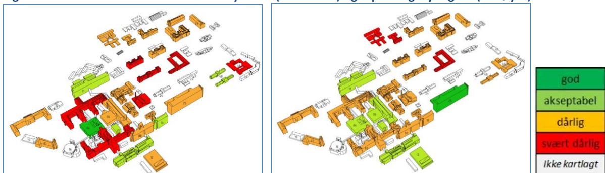
Figur 7: Oversikt teknisk tilstand Ullevål sykehus (til venstre) og tilpasningsdyktighet (til høyre)
