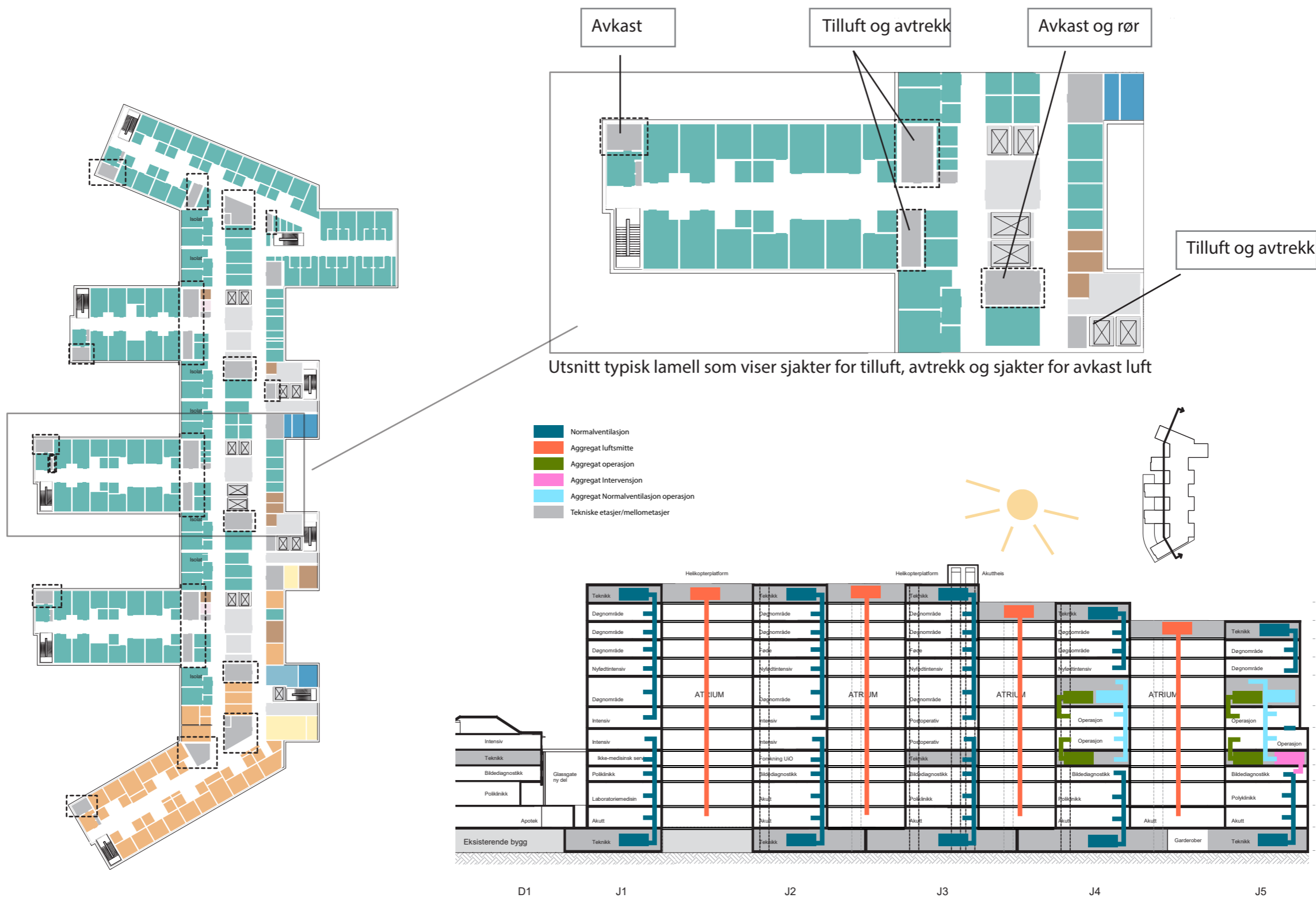
Typisk etasje med sjakter for ventilasjon markert
