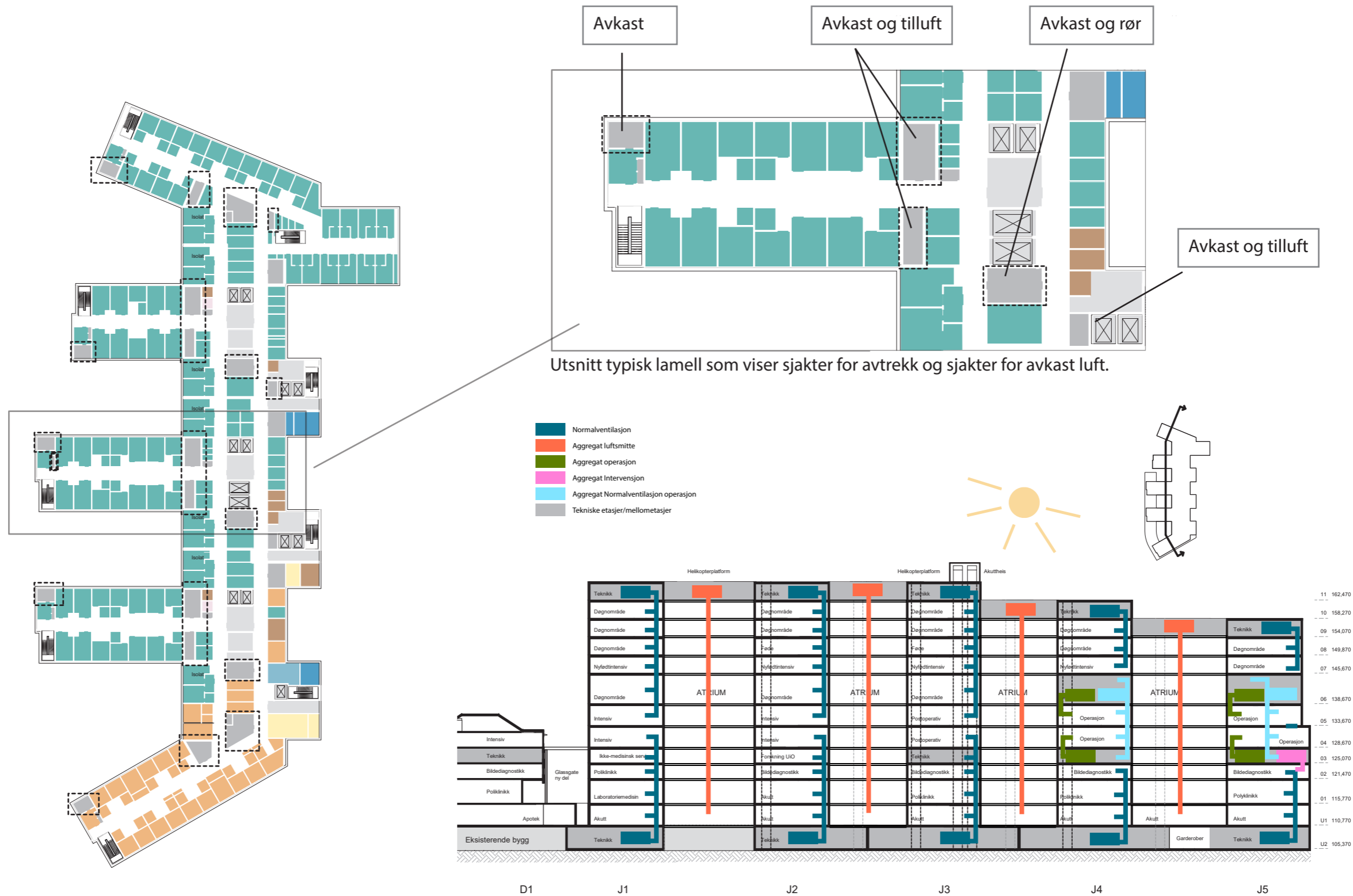
Typisk etasje med sjakter for ventilasjon markert
