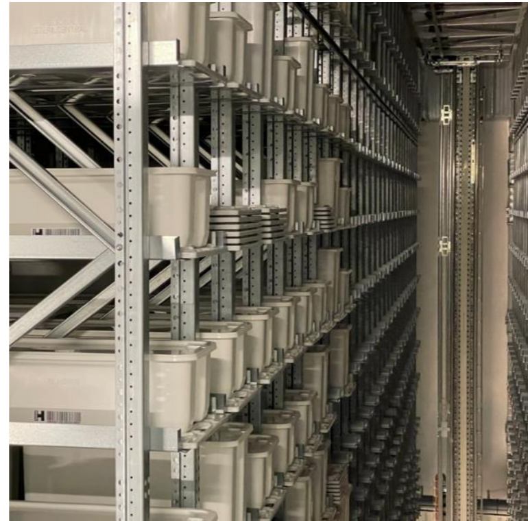
Eksempel på automatisert sterilt lager med kasser og tomme stablede transportplater
