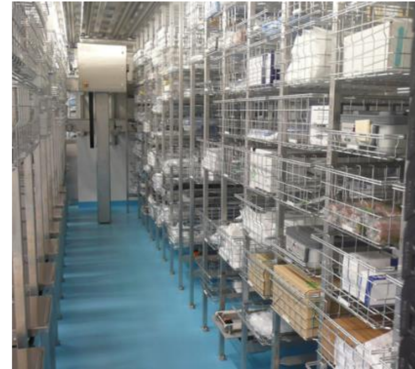
Eksempel på automatisert sterilt lager med plukkstasjoner for plukking av engangsartikler til prosedyreset
