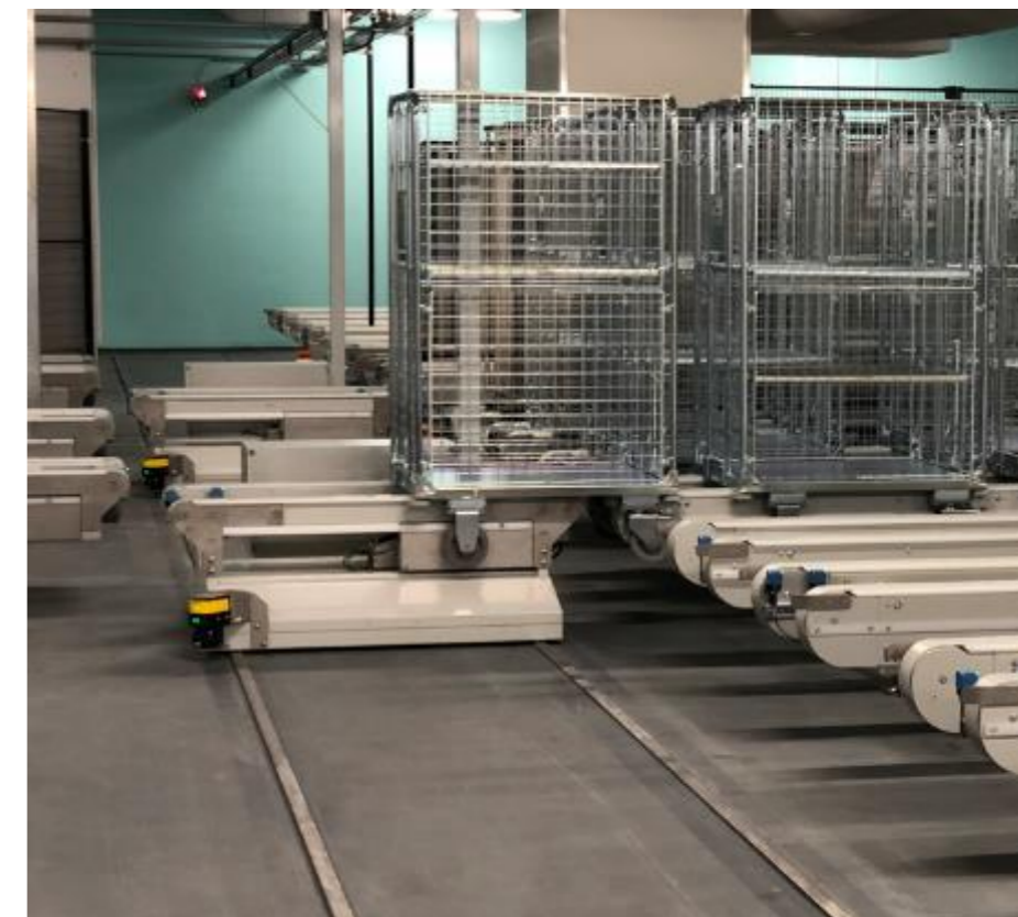
Eksempel på automatiske transfervogner for håndtering av vogner mellom transportbaner
