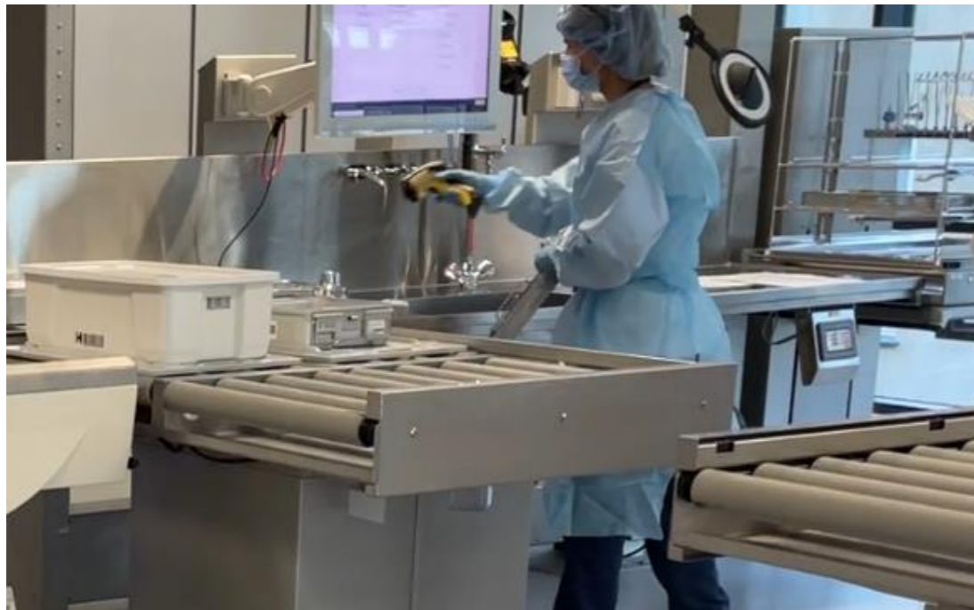
Eksempel på vaskebord med automatisert transport av containere og kasser
