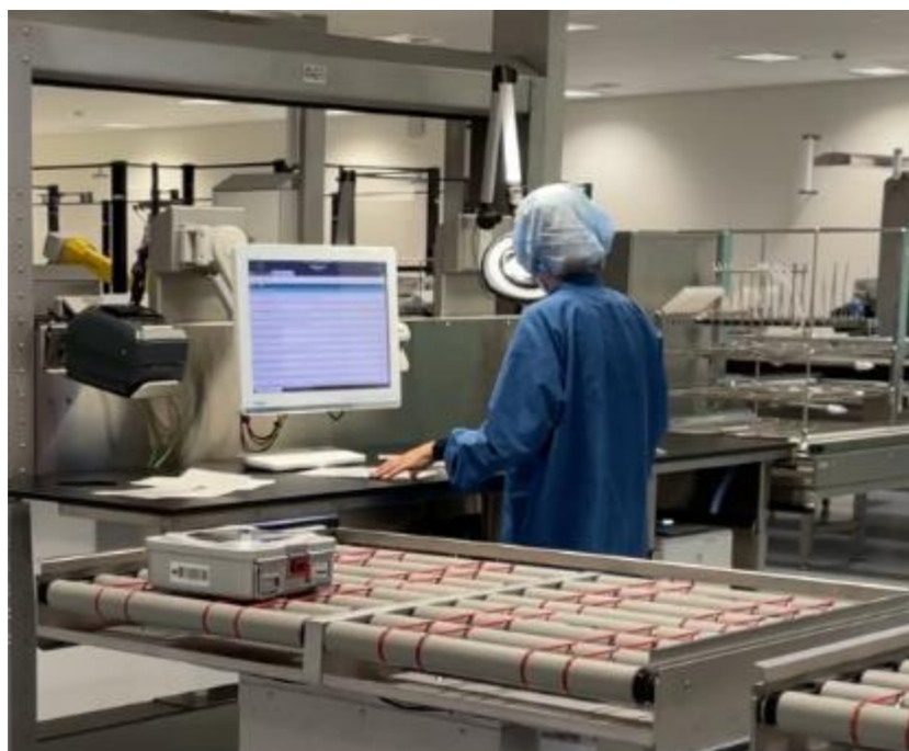
Eksempel på pakkebord med automatisert transport av containere og autoklavkurver
