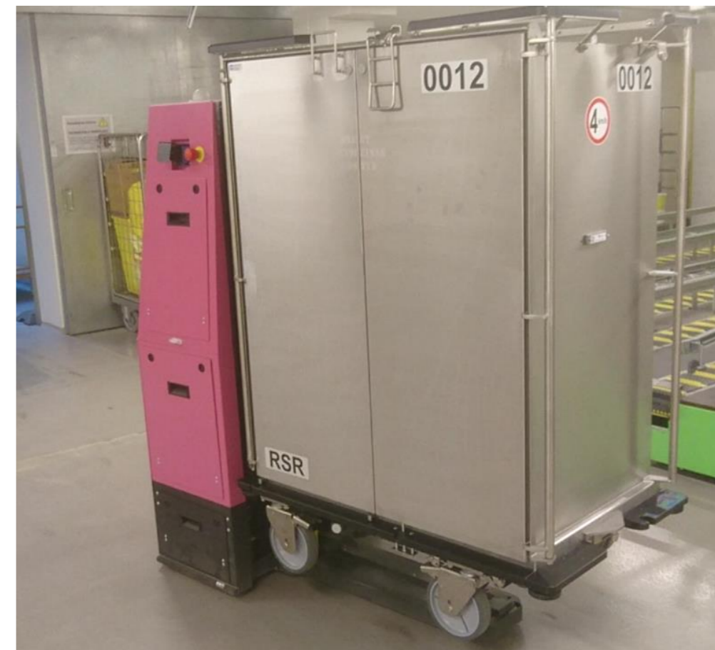
Eksempel på AGV som kjører med transportvogner
