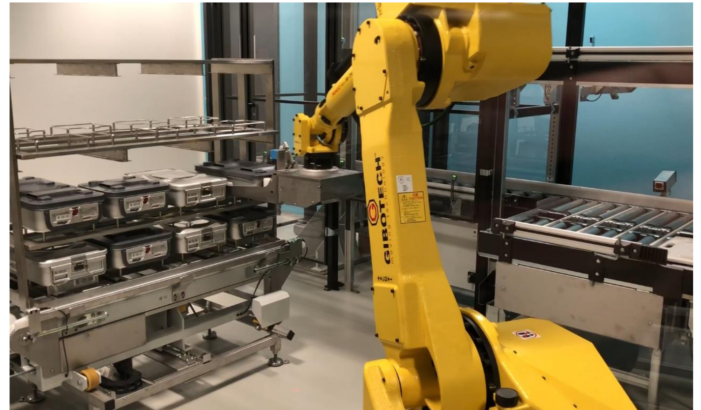
Eksempel på robot som tømmer autoklavstativer
