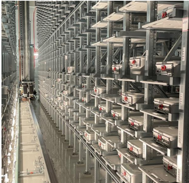
Eksempel på automatisert sterilt lager med containere
