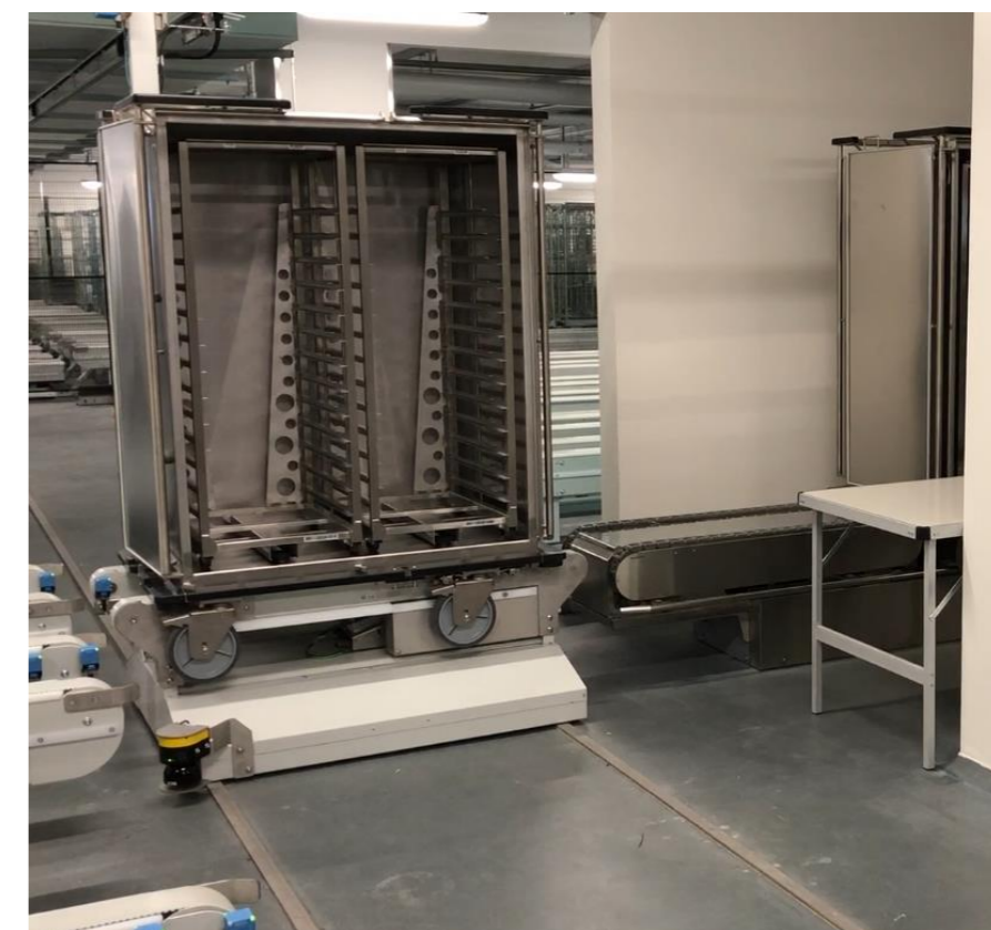
Eksempel på automatisk overføring av tomme transportvogner fra transportbaner til innlastere til vognvaskmaskiner
